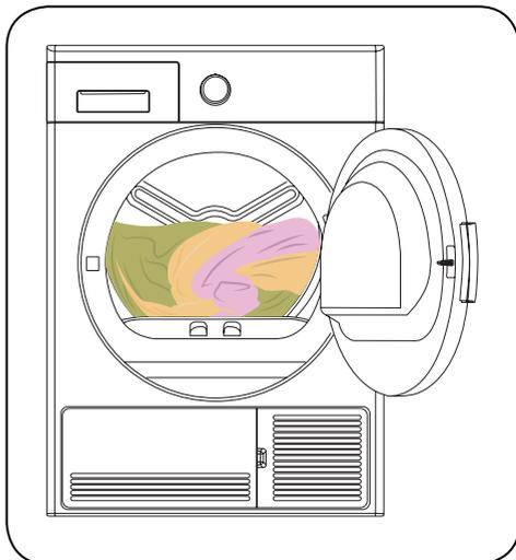
**⚠ IMPORTANT :** Il n'est pas recommandé de charger le séchoir à linge avec une quantité de linge supérieure à celle indiquée sur la figure. Lorsqu'il est surchargé, sa performance de séchage diminue, ce qui peut causer des dommages au séchoir à linge et au linge.
